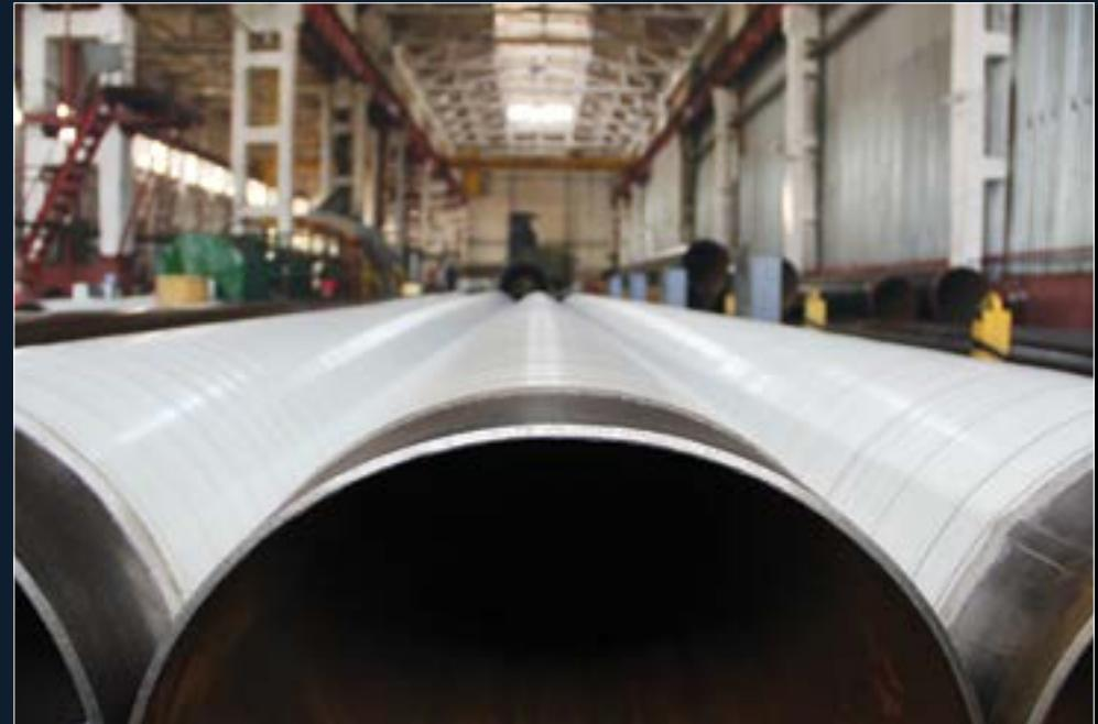
На протяжении трех лет специалисты нашей компании проводили исследования и получили новый уникальный продукт: На базе завода в Балакирево теперь производится новый вид изоляции – Двухслойное полимерное покрытие (ДПП). Оно обладает, при прочих равных характеристиках по защите от коррозии и блуждающих токов, еще и высокой температурной стойкостью, что дает возможность использовать данную изоляцию на несущих трубопроводах с температурой теплоносителя до 150 градусов по Цельсию.
