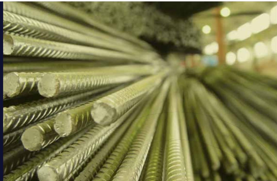
Предлагаемая арматура является диамагнитной и имеет диэлектрические свойства, что позволяет применять ее в таких зданиях и сооружениях, как больницы, аэропорты, радиолокационные станции, различные военные сооружения. Теплопроводность композита более чем в сто раз ниже, чем у стали
